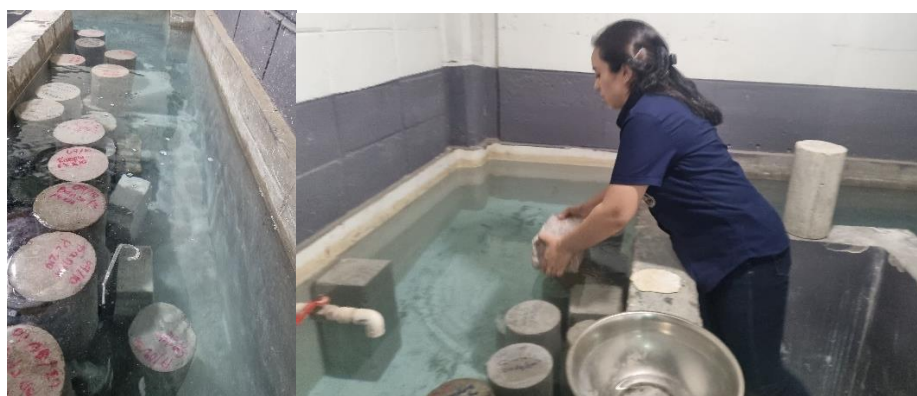
Ilustración 21: Colocación de los materiales impermeabilizados en la pileta con agua.
