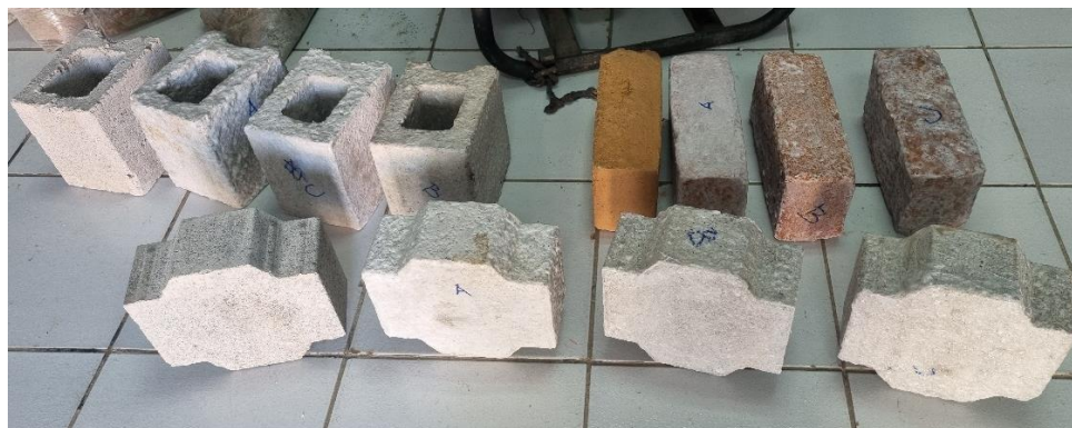
Ilustración 19: Materiales a los que se les realizó el ensayo de absorción.
