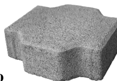
Material: Adoquín de concreto
