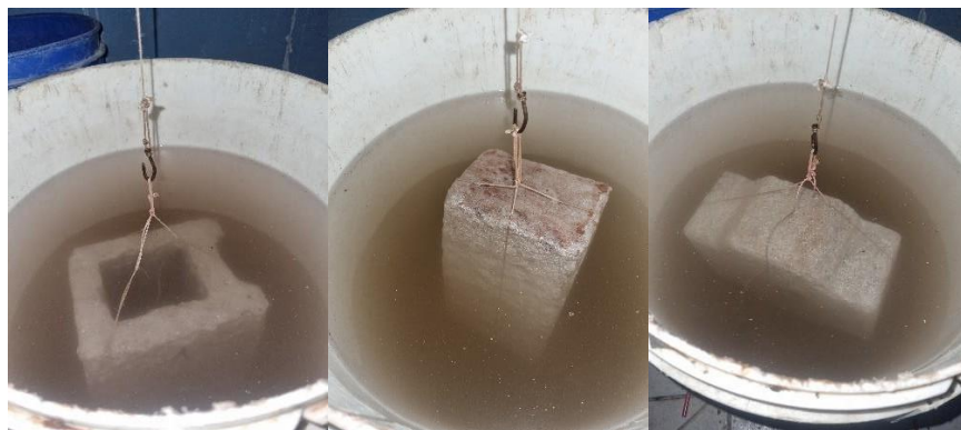
Ilustración 23: Peso del material sumergido en agua (Peso sum.).
