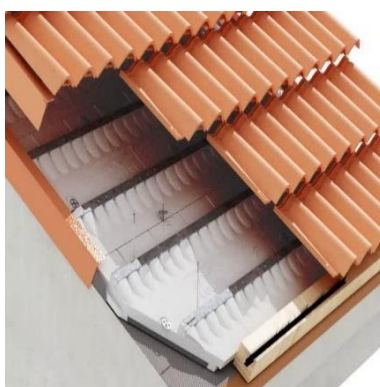
Ilustración 5: Utilización de EPS como aislante térmico en la construcción.
