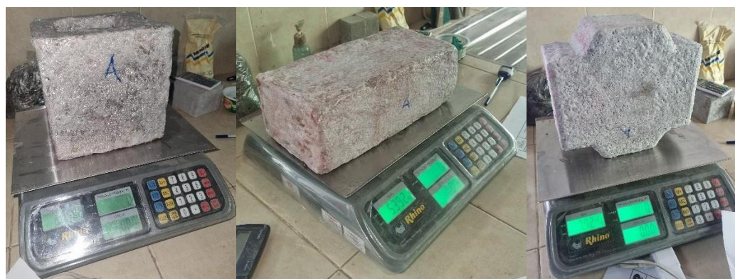
Ilustración 22: Peso del material Saturado superficialmente seco (Peso SSS).
