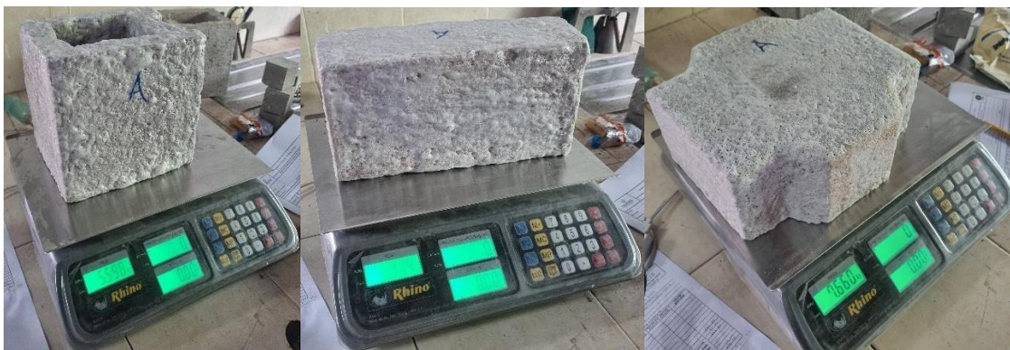
Ilustración 20: Toma de peso de los materiales impermeabilizado (Peso seco).
